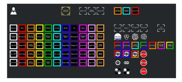
In der oberen Reihe sind in der Mitte verschiedene Optionen für Nebel zu finden. Fog Full Autooff kann genutzt werden, wenn eine Nebelmaschine angeschlossen ist um einen Nebelstoß von einer Sekunde Dauer zu erzeugen. Hazer min erzeugt dauerhaft 10% Hazeausstoß mit einer dezenten Lüftersteuerung, Hazer medium erzeugt dauerhaft 30% Hazeausstoß mit angepasstem Lüfter und Hazer off schaltet den Hazer ab.
